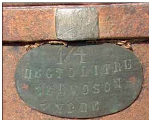
Detail met weggekraste pegel en ovaal koperen fabrikantenplaatje: 1/4 HECTOLITRE GERVOSON A YPRES
