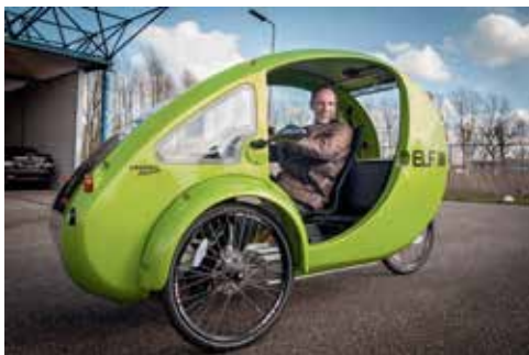
Overdekte fiets met zonnepaneel en accu.
